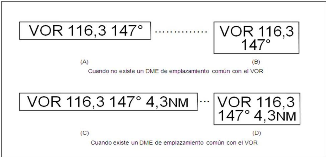
**Figura E-33. Letreros de punto de verificación del VOR en el aeródromo**
